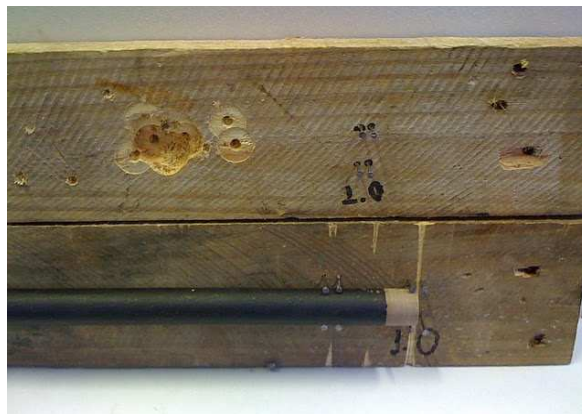
Figura 26: Molde de madeira de corte dos tubos com marcação de 1 metro.
