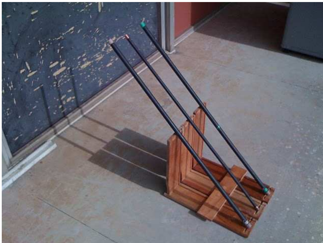
Figura 12: Tubos de PVC, cobre e PPR situados a 100 mm de distância.
