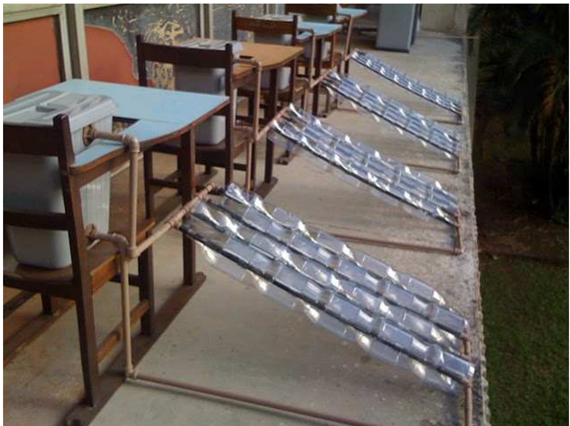
Figura 11: Módulos com diferentes tamanhos de garrafas situados lado a lado.
