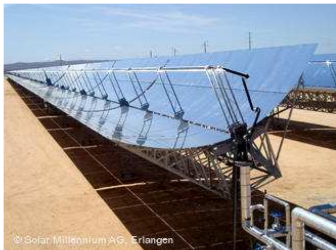
Figura 2: Espelhos parabólicos para concentração de raios solares no tubo.
